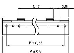
基板取付穴寸法(参考・装着面)
