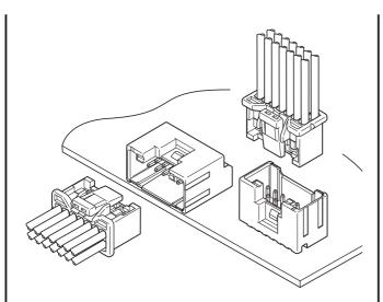
2.0mmピッチ、圧着タイプ、2列構造を採用した強ロック 付基板対電線接続用コネクタです。低挿入力化を実現しな がらも振動やこじり、微小電圧・電流回路に対しても安定し た接触状態を発揮します。また、ロック解除時に投影面積 内にてロック解除が可能な形状です。
